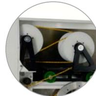
Reduzierte Belastung auf Hauptkomponenten durch spannungsentlasteten Seil-speicher.
