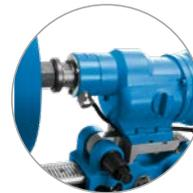
3-Gang-Getriebe mit Ölbad-schmierung, Überlastkupp-lung und Ölpumpe
