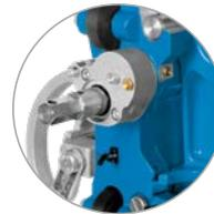
Ermüdungsfreies, ergonomisches Arbeiten dank Vorschub-Feingetriebe ( $i=1:3,5$ )
